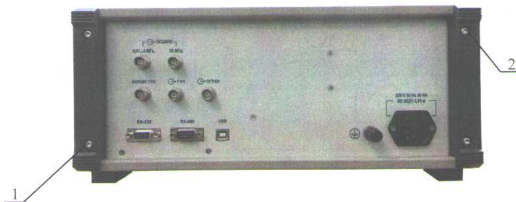
1, 2 - места пломбировки от несанкционированного доступа Рисунок 2 - Схема пломбировки калибраторов
